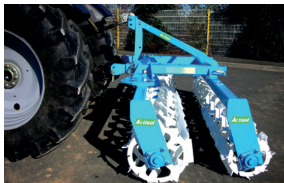
Exemple d'outil cumulant deux rouleaux © MatéVi
